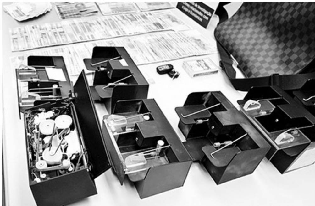
图36 假冒洗牌机中的摄录装置 [237]
