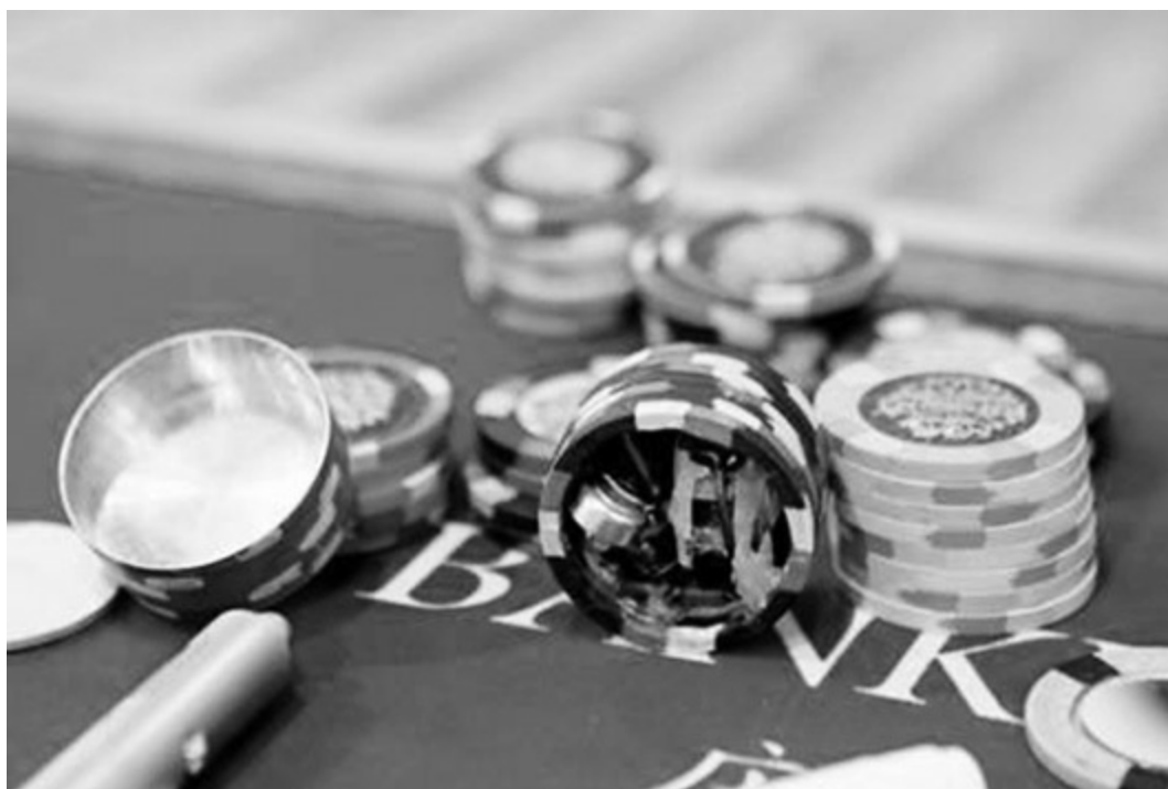
图37 伪造筹码中的摄录装置
